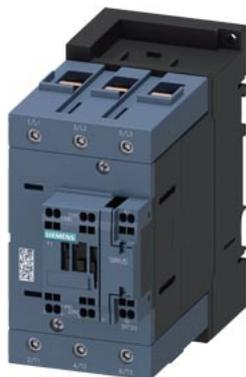
Contator de potência, CA-3 95 A, 45 kW / 400 V 1 NA + 1 NF, 110 V CA, 50 Hz 120 V/60 Hz de polos, 3NA, tamanho S3 conexão de mola
