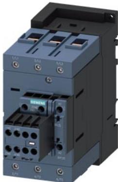
Contator de potência, CA-3 95 A, 45 kW / 400 V 2 NA + 2 NF, 110 V CA, 50 Hz de 3 polos, 3NA, tamanho S3 conexão parafusada
