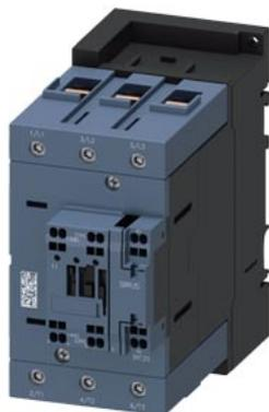
Contator de potência, CA-3 80 A, 37 kW / 400 V 1 NA + 1 NF, 20-33 V CA/CC com capacidade de comunicação de 3 polos, 3NA, tamanho S3 conexão de mola varistor integrado
