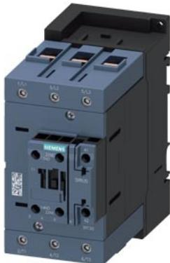
Contator de potência, CA-3 80 A, 37 kW / 400 V 1 NA + 1 NF, 175-280 V CA/CC de 3 polos, 3NA, tamanho S3 conexão parafusada varistor integrado
