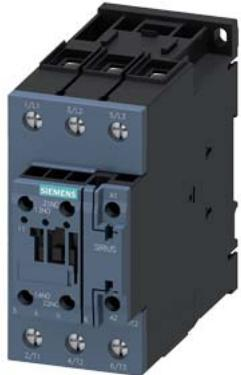
Contator de potência, CA-3 65 A, 30 kW / 400 V 1 NA + 1 NF, CA / CC 20-33 V, com capacidade de comunicação com varistor, de 3 polos tamanho S2, conexão parafusada
