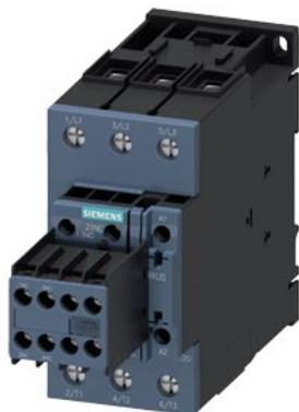
Contator de potência, CA-3 40 A, 18,5 kW / 400 V 2 NA + 2 NF, CA / CC 20-33 V, com varistor, de 3 polos, tamanho S2, conexão parafusada
