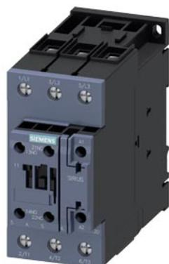
Contator de potência, CA-3 40 A, 18,5 kW / 400 V 1 NA + 1 NF, CA / CC 20-33 V, com varistor, de 3 polos, tamanho S2, conexão parafusada
