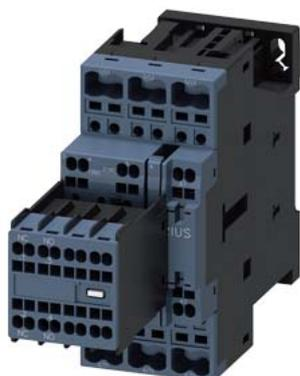
Contator de potência, CA-3 38 A, 18,5 kW / 400 V 2 NA + 2 NF, 220 V CA 50/60 Hz, de 3 polos tamanho S0, conexão de mola interruptor auxiliar removível
