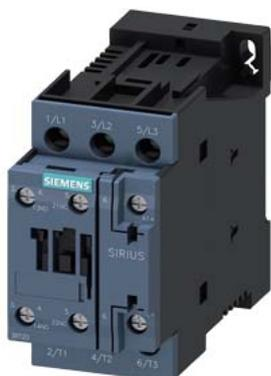
Contator de potência, CA-3 38 A, 18,5 kW / 400 V 1 NA + 1 NF CA (50 - 60 Hz) / CC 21-28 V CA / CC, de 3 polos tamanho S0, conexão parafusada tamanho S0, conexão parafusada
