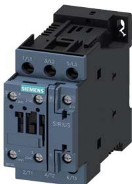
Contator de potência, CA-3 38 A, 18,5 kW / 400 V 1 NA + 1 NF, 24 V CC com capacidade de comunicação, de 3 polos tamanho S0, conexão parafusada
