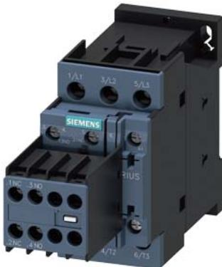
Contator de potência, CA-3 38 A, 18,5 kW / 400 V 2 NA + 2 NF, 24 V CA 50 Hz, de 3 polos, tamanho S0 conexão parafusada interruptor auxiliar removível
