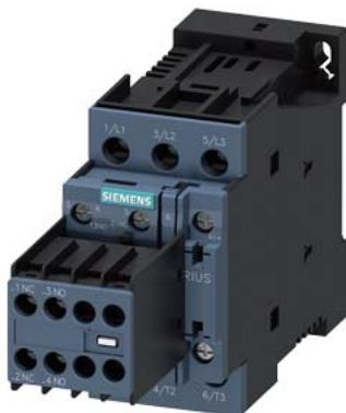
Contator de potência, CA-3 32 A, 15 kW / 400 V 2 NA + 2 NF, 24 V CC de 3 polos, tamanho S0 conexão parafusada interruptor auxiliar removível
