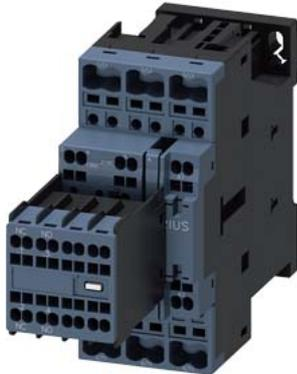
Contator de potência, CA-3 25 A, 11 kW / 400 V 2 NA + 2 NF, 24 V CA, 50 / 60 Hz, de 3 polos, tamanho S0, conexão de mola interruptor auxiliar removível
