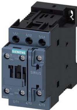
contactor de potência, CA-3 17 A, 7,5 kW / 400 V 1 NA + 1 NF, 24 V CC com varistor integrado de 3 polos, tamanho S0 conexão parafusada adequado para saídas CLP não expansível com interruptor auxiliar
