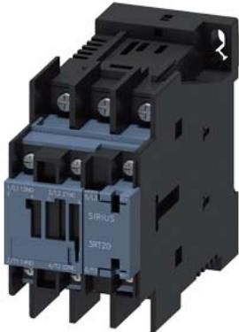
Contator de potência, CA-3 12 A, 5,5 kW / 400 V 1 NA + 1 NF, 24 V CC de 3 polos, tamanho S0 conexão de terminal de cabo anular
