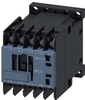
Contator de potência, CA-3 16 A, 7,5 kW / 400 V 1 NF, 24 V CC de 3 polos, tamanho S00 conexão de terminal de cabo anular
