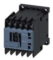
Contator, CA-3, 7,5 KW / 400 V, 1 NF, 100 V CA, 50 Hz, 100  $\dots$  110 V, 60 Hz, de 3 polos, tamanho S00, conexão de terminal de cabo anular
