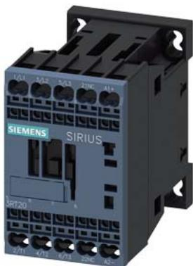
Contator de potência, CA-3 16 A, 7,5 kW / 400 V 1 NF, 24 V CC com integrado diodo, de 3 polos, tamanho S00 conexão de mola
