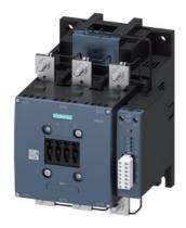
Contator, CA-1, 500 A/690 V/40 °C, S10, de 3 polos, 96-127V CA/CC, CLP-IN opcional, com varistor, 1NA+1NF, trilho de conexão/ conexão parafusada
