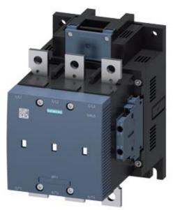
Contator a vácuo, CA-3 265 A, 132 kW / 400 V CA (50-60 Hz) / acionamento CC UC 23-26V contatos auxiliares 2 NO + 2 NF de 3 polos, tamanho S10 conexões de barramento unidade propulsora: convencional
