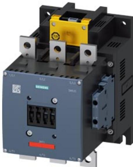
Contator de potência, CA-3 225 A, 110 kW / 400 V bobina CA 50/60 Hz e CC 96-127 V x (0,8-1,1) F-CLP entrada 24 V CC 3 polos tamanho da estrutura S10 contatos auxiliares 2 NA + 2 NF não removível corrente principal: barramento circuito auxiliar e circuito de comando: conexão parafusada
