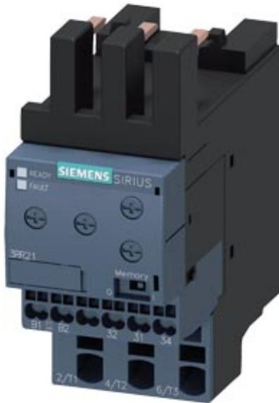
relé de monitoramento, montável em contactor 3RT2, tamanho S0 básico, ajustável analogicamente motonitoração de corrente aparente 4...40 A, 50...60 Hz, de 2 fases alimentação 24 V CA/CC 1 contato inversor motonitoramento de valor limite de corrente ultrapassado e não alcançado falha de fase, ruptura de fio com ou sem registro de erros retardamento de partida 0-60 s supressão dos picos de emissão 0-30 s histerese de comutação 6% técnica de ligação por mola
