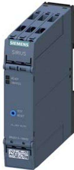
relé de proteção de motor por termistor aparelho padrão de avaliação carcaça de 22,5 mm conexão parafusada 2 contato inversor US = CA/24 V CC-240 V RESET Manual/Automático/Remoto com aprovação ATEX 2 LEDs (ready/tripped) separação galvânica de proteção botão de teste/RESET motonitoração da ruptura de fio motonitramento de curto-circuito com proteção de tensão zero
