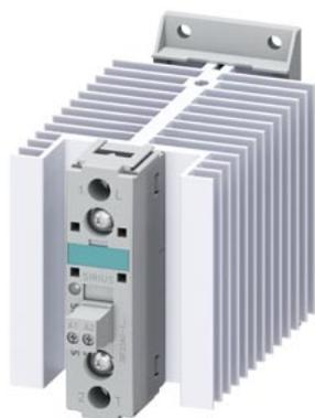
contator semicondutor de 1 fase 3RF2 CA 51 / 40 A / 40 °C 48-460 V / 24 V CC low power à prova de curto-circuito até 25 A com B-Automat
