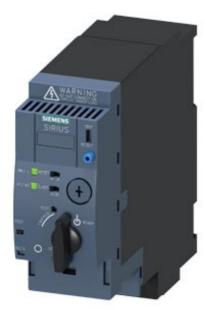
SIRIUS derivação compacta motor de partida direta 690 V CA/CC 110...240 V 50...60 Hz 0,32...1,25 A IP20 conexão do circuito de corrente principal: encaixável, sem terminais conexão do circuito de corrente auxiliar: encaixável, sem terminais
