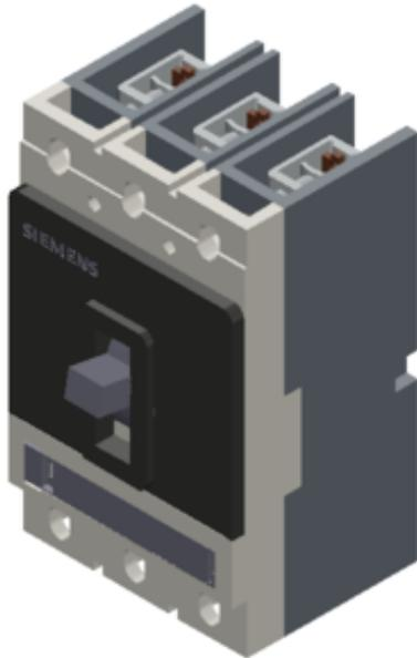
Interruttore VL160L potere di interruzione elevatissimo  $I_{cu}=100 \text{ kA}$ , AC 415 V a 3 poli, protezione impianto sganciatore di sovracorrente ETU22, LSIG 3 fasi / 4 conduttori con cavo di collegamento  $I_n=160\text{A}$ , corrente nominale  $I_r=64 \dots 160 \text{ A}$ , protezione da sovraccarico,  $ISD=1,5 \dots 10x I_r$ ,  $II=11x I_N$  protezione da cortocircuito senza sganciatore ausiliario senza blocchetto di contatti ausiliari/di allarme
