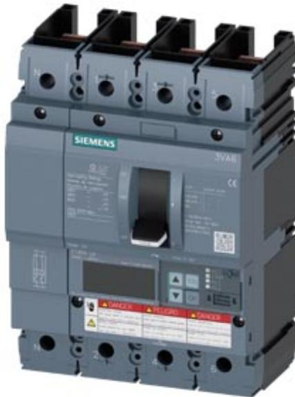
interruttore automatico 3VA6 UL frame 150 classe del potere di interruzione L 150 kA @ 480 V a 4 poli, protezione impianto ETU850, LSI, In=100 A protezione da sovraccarico Ir=40 A ... 100 A protezione da cortocircuito I<sub>sd</sub>=0,6..10x I<sub>n</sub>, I<sub>i</sub>=1,5..12x I<sub>n</sub> protezione del conduttore di neutro regolabile (OFF, fino a 150 %) senza collegamento
