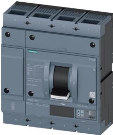
Interruttore 3VA2 IEC Frame 1000 Classe del potere di interruzione C Icu=110kA @ 415V a 4 poli, protezione impianto ETU860, LSIG, In=1000A protezione da sovraccarico Ir=400 A ... 1000 A protezione da cortocircuito I<sub>sd</sub>=0,6..10x I<sub>n</sub>, I<sub>i</sub>=1,5..10x I<sub>n</sub> protezione del conduttore di neutro impostabile (OFF, fino a 100%) protezione da guasto verso terra, disinseribile I<sub>g</sub>=0,2...1 x I<sub>n</sub>= tg=0,05-0,8s attacco piatto a vite
