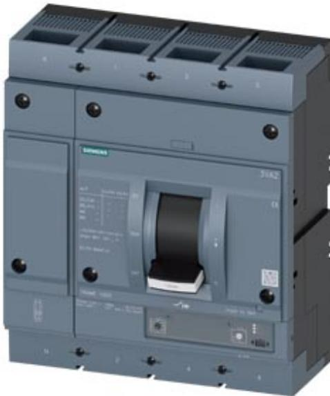
Interruttore 3VA2 IEC Frame 1000 Classe del potere di interruzione C Icu=110kA @ 415V a 4 poli, protezione impianto ETU340, ELISA LI, In=1000A protezione da sovraccarico Ir=400 A ... 1000 A protezione da cortocircuito Ii=10 x In protezione del conduttore di neutro impostabile (OFF, 50%, 100%) attacco piatto a vite
