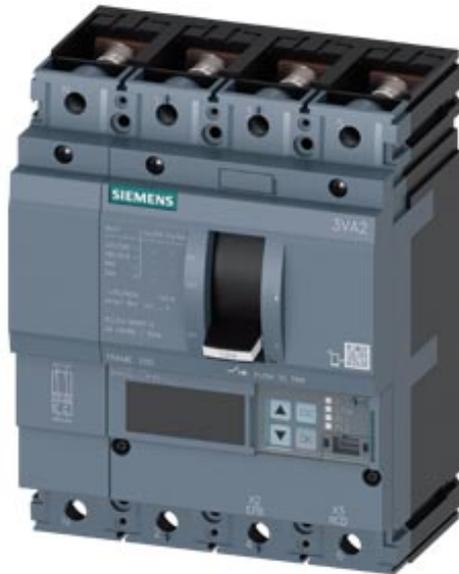
Interruttore automatico 3VA2 IEC Frame 100 Classe del potere di interruzione M Icu=55kA @ 415V a 4 poli, protezione impianto ETU550, LSI, In=100A protezione da sovraccarico Ir=40A...100A protezione da cortocircuito I<sub>sd</sub>=0,6..10x I<sub>n</sub>, I<sub>i</sub>=1,5..12x I<sub>n</sub> protezione del conduttore di neutro impostabile (OFF, fino a 100%) attacco piatto a vite
