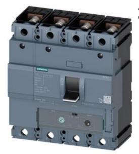
Interruttore automatico 3VA1 IEC Frame 250 Classe del potere di interruzione H Icu=70kA @ 415V a 4 poli, protezione impianto TM240, ATAM, In=200A protezione da sovraccarico Ir=140 A ... 200 A protezione da cortocircuito Ii=5 ... 10 x In protezione del conduttore di neutro 100% attacco piatto a vite
