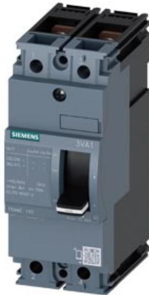
interruttore automatico 3VA1 IEC frame 160 classe del potere di interruzione  $S I_{cu}=36kA @ 415V$  a 2 poli, protezione impianto TM210, FTFM,  $I_n=40A$  protezione da sovraccarico  $I_r=40 A$  con regolazione fissa protezione da cortocircuito  $I_i=10 \times I_n$  attacco piatto a vite
