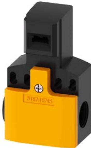
finecorsa di sicurezza con azionatore separato custodia in plastica, 50 mm connessione dell'apparecchio 2x (M20x 1,5) contatti ad azione lenta 1NO+2NC 5 direzioni di accostamento il relativo attuatore separato 3SE5000-0AV0. deve essere ordinato separatamente
