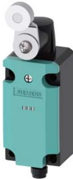
interruttore di posizione custodia in metallo 40 mm secondo DIN EN 50041 contatti ad azione rapida 1NO/1NC con 2 LED, giallo/verde, DC 24 V attuatore a frazione di giro impostabile a destra e/o sinistra, leva in metallo lungo 27 mm e rotella in acciaio inox 19 mm
