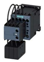
contattore per condensatore, AC-6b 12,5 kVAr, / 400 V 2 NC, AC 24 V, 50/60 Hz a 3 poli, grandezza costruttiva S00 morsetto a vite
