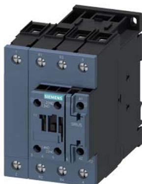
contattore di potenza, AC-3 40 A, 18,5 kW / 400 V 2 NO + 2 NC AC 24 V, 50 Hz a 4 poli grandezza costruttiva S2 morsetto a vite 1 NO + 1 NC integrato
