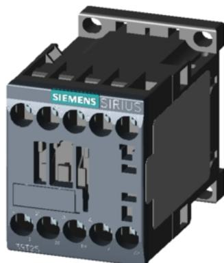
contattore, 2 NO+2 NC, AC-3, 5,5 kW, AC 110 V, 50 Hz, 120 V, 60 Hz, a 4 poli, 2 NO+2 NC, grandezza costruttiva S00, morsetto a vite
