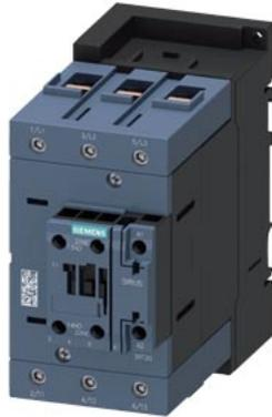
contattore, AC-1, 160 A/690 V/40 °C, S3, a 3 poli, AC/DC 175 ... 280 V, con varistore, 1NO+1NC, morsetti serracavo/morsetti a vite
