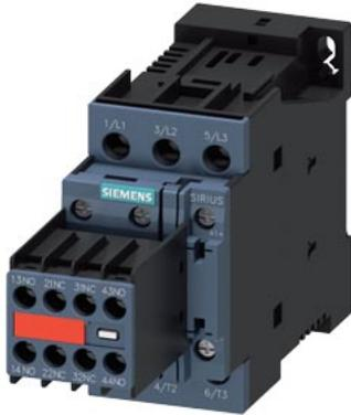
contattore di potenza, AC-3 17 A, 7,5 kW / 400 V 2 NO+2 NC, DC 24 V, con varistore innestato a 3 poli, grandezza costruttiva S0 morsetti a vite
