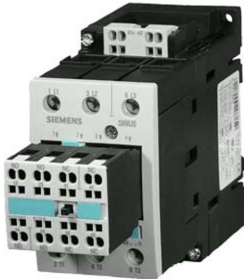
contattore di potenza, AC-3 40 A, 18,5 kW / 400 V DC 48 V, 2 NO + 2 NC a 3 poli, grandezza costruttiva S2 circuito principale: morsetto a vite, circuito ausiliario: morsetto a molla !! Prodotto di fine serie !!! Il successore è SIRIUS 3RT2 Il successore consigliato è >>3RT2028-2BW40<<
