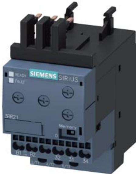
relè di controllo, applicabile al contattore 3RT2, grandezza costruttiva S00 Basic, a impostazione analogica sorveglianza di corrente apparente 1,6 ... 16 A, 20 ... 400 Hz, bifase alimentazione AC/DC 24 V 1 contatto CO controllo di superamento in positivo e in negativo della corrente mancanza di fase, rottura conduttore con o senza memorizzazione errore ritardo all'avvio 0-60 s soppressione picchi di interferenze 0-30 s isteresi di commutazione 6% tecnica di collegamento a molla
