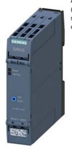
relè protezione motore a termistore unità di controllo standard custodia 22,5 mm morsetto a molla 2 contatti CO bistabili US = AC/DC 24 V ... 240 V reset manuale/automatico/remoto 2 LEDs (READY/TRIPPED) separazione galvanica tasto Test/RESET sorveglianza rottura conduttore sorveglianza di cortocircuito a prova di mancanza tensione
