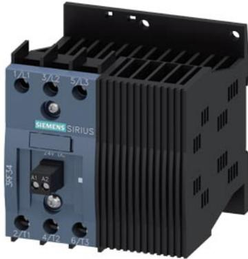
Contattore statico trifase 3RF3 AC 53 / 16 A / 40 °C 48-480 V / DC 24 V a comando bifase con commutazione istantanea morsetto a vite
