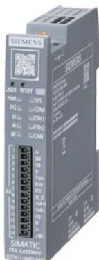
SIMATIC FDE Gateway V1 Field Data Enabler / OT passerelle pour connexions cloud 1xDI 12/24 V - 1xDQ 24 V 1xAI 0...10V ou 4...20mA 2x 10/100 Mbits/s alimentation industrielle DC 24V
