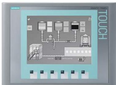
SIMATIC HMI KTP600 Basic mono PN, Basic Panel, Commande par touches/tactile, écran STN 6", 4 niveaux de gris, interface PROFINET, configurable à partir de WinCC flexible 2008 SP2 Compact/ WinCC Basic V10.5/ STEP 7 Basic V10.5, contient un logiciel en open source, qui est est cédé à titre gratuit voir CD joint
