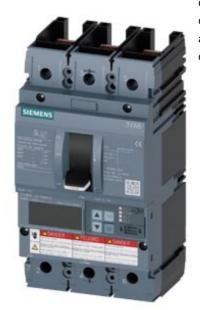
Disjoncteur 3VA6 UL cadre 150 classe de coupure L 150kA @ 480 V 3 pôles, protection des installations ETU856, LSI, In=100A protection contre les surcharges Ir=40A...100A protection contre les courtscircuits Isd=0,6..10x In, Ii=1,5..12x In protection du neutre en option avec transformateur de courant externe, jusqu'à 160% alarme de défaut à la terre Message via EFB300 O. COM sans raccordement
