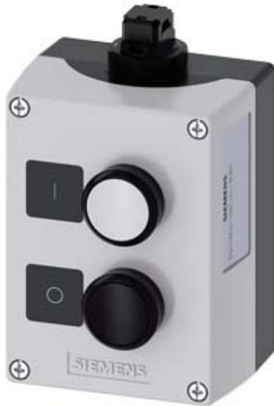
Boîtier AS-Interface pour appareils de commande, 22 mm, rond, matériau du boîtier : plastique, partie supérieure du boîtier : gris, 2 emplacements de commande en plastique, renforcement pour plaquettes, B = bouton-poussoir blanc, plaquette : I, 1 NO, borne à ressort, A = poussoir noir, plaquette : O 1 NF, borne à ressort, fixation au sol, raccordement par prises vampires en haut, étiquettes jointes
