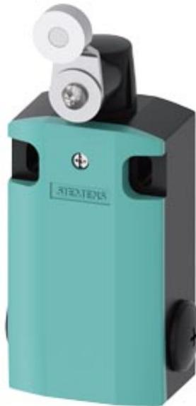
Interrupteur de position SIRIUS Boîtier métallique XL, 56 mm de large, avec levier à galet pivotant 27 mm en acier inox, galet en acier inoxydable 19 mm, Raccordement d'appareil 3 x(M20x1,5), Protection augmentée contre la corrosion (EKS) Contacts dorés: 2x(1 NO / 1 NF) contacts à action brusque, IP66 / IP67
