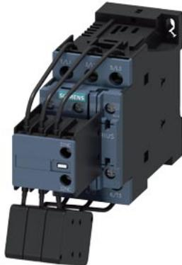
Contacteur de condensateur, AC-6b 16,7 kVA<sub>r</sub> / 400 V 1 NO + 2 NF, CA 50-60 Hz CC 95-130 V 3 pôles, taille S0 borne à vis
