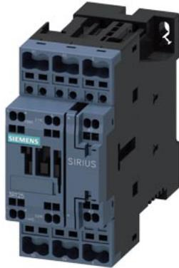
Contacteur de puissance, AC-3 25A, 11 kW / 400 V 2 NO + 2 NF 110 V CC, 50 Hz 4 pôles taille S0 borne à ressort 1 NO + 1 NF intégrés
